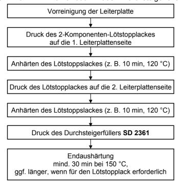
• bei Verwendung eines fotostrukturierbaren 2-Komponenten-Lötstopplackes, z. B. aus der Reihe **ELPEMER**® **2467** oder **2469 SM** in Kombination mit dem Durchsteigerfüller **SD 2361**:
